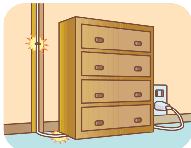
危険 コードが家具の下敷きになることやステップル止めはショートや火災の原因に
