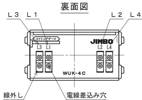
■適用電線：銅単線  $\phi 0.4 \sim \phi 0.65$
