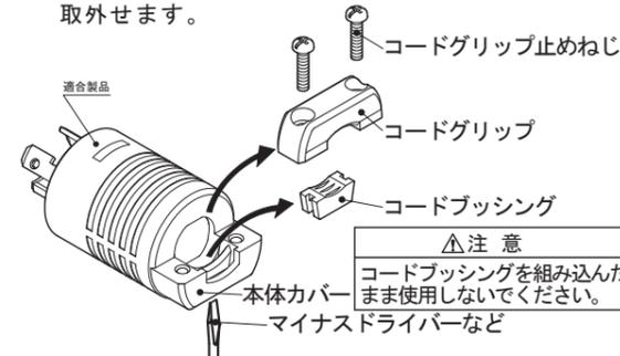
2. 結線後、適合製品のコードグリップ止めねじで本製品を組み込み、本製品と本体カバーが密着するまで、確実にねじ止めしてください。
