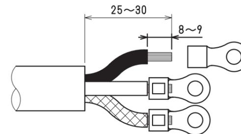
心線の被覆を剥き、圧着工具を用いて圧着端子を心線に確実にかしめてください。
